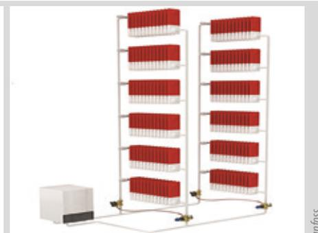
Hydraulisch abgeglichenes Heizkörpersystem
