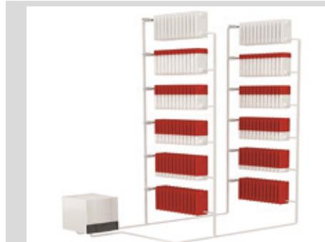
Heizkörpersystem ohne hydraulischen Abgleich
